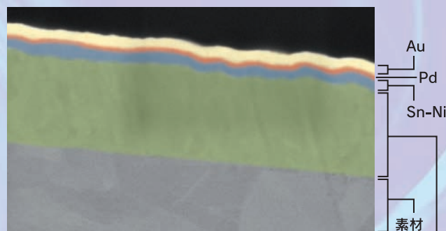
※上記画像は、断面層をわかりやすくするためにSEM像に着色を施しています。 1.00μm イオウレスNi
